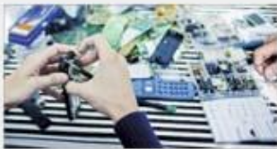
Démontage d'un téléphone portable en vue de son recyclage.
