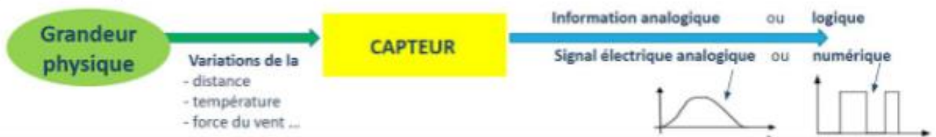
Principe de fonctionnement d'un capteur
